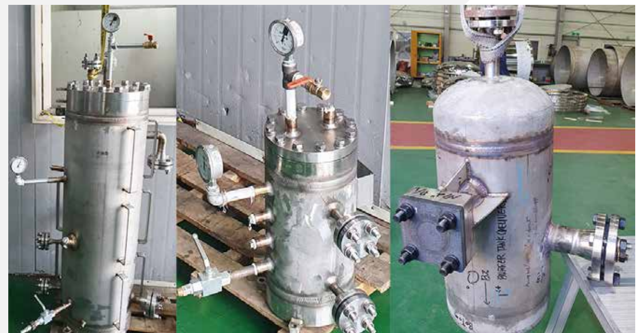
암모니아(NH3) 압축기 완충장치 기기
